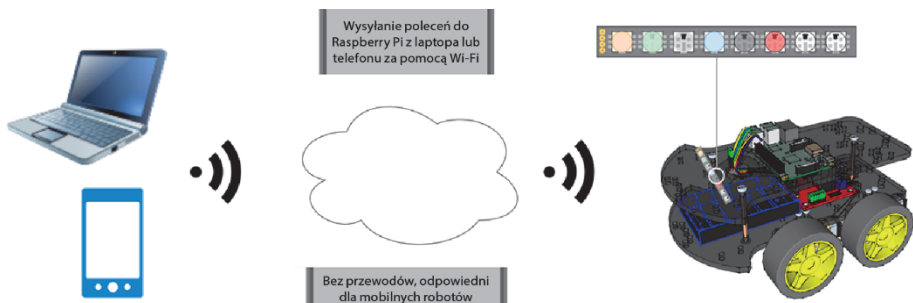
Rysunek 4.2. Raspberry Pi w robocie „bez głowy”
